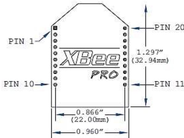
Figure 3. The XBee PRO 900HP module
